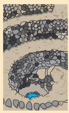
el agua del socavón hacia unas cochas o reservorios, para de ahí conducirla a los campos por medio de canales. Las paredes de los socavones están recubiertas de piedras sostenidas por maderos de quarango.
